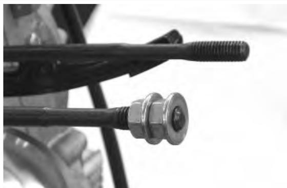
Au moyen de deux écrous de fixation culasse montés type écrou et contre-écrou comme indiqué sur la photo, déposer le goujon de son logement. Effectuer un nettoyage soigné du logement fileté sur le carter.
