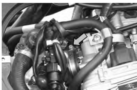
Installer l'outil spécifique de contrôle de la pression du carburant et placer le collecteur sur un récipient gradué d'au moins 100 cm<sup>3</sup>. Brancher l'injecteur sur le câble fourni pour le testeur d'injection. Brancher les cosses du câble sur une batterie auxiliaire. Mettre en route la pompe à essence avec le diagnostic actif. Vérifier si dans 15 secondes une quantité de carburant d'environ 40 cm<sup>3</sup> est fournie à une pression de réglage d'environ 2,5 bar.
