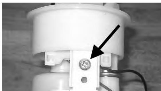
Retirer le collier de fixation de la tuyauterie au fil-tre, indiqué sur la photo.
