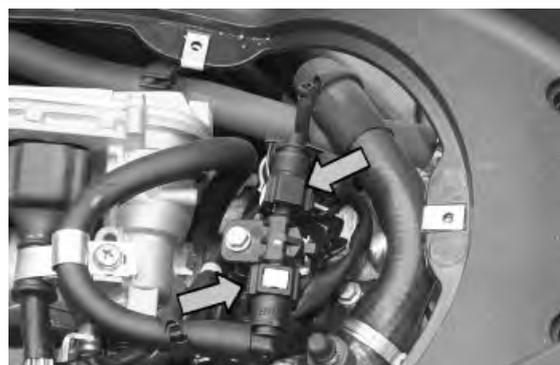
Déposer le connecteur de l'injecteur et l'injecteur.
