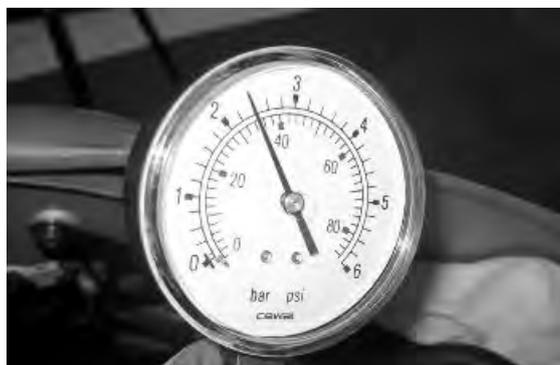
Avec tension de batterie > 12 V, vérifier le débit de la pompe en débranchant le tuyau muni de manomètre de l'outil spécifique de l'injecteur. Préparer une burette graduée ayant une capacité d'environ 1 L. Faire tourner la pompe au moyen des diagnostics actifs de l'ordinateur de poche. Au moyen d'une pince aux becs longs et plats, étrangler le tuyau carburant en faisant stabiliser la pression à environ 2,5 bar. Vérifier qu'en 15 secondes la pompe a un débit d'environ 110 cm<sup>3</sup>.
