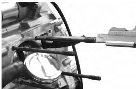
Au moyen de deux écrous de fixation culasse montés type écrou et contre-écrou comme indiqué sur la photo, enlever le goujon de son logement. Effectuer un nettoyage soigné du logement fileté sur le carter.
