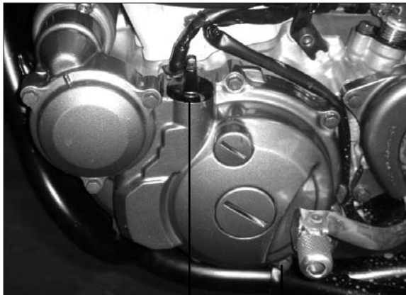
Bouchon remplissage Vis de vidange et vis de niveau
