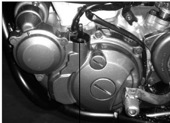
Tappo riempimento Vite di drenaggio e livello olio
