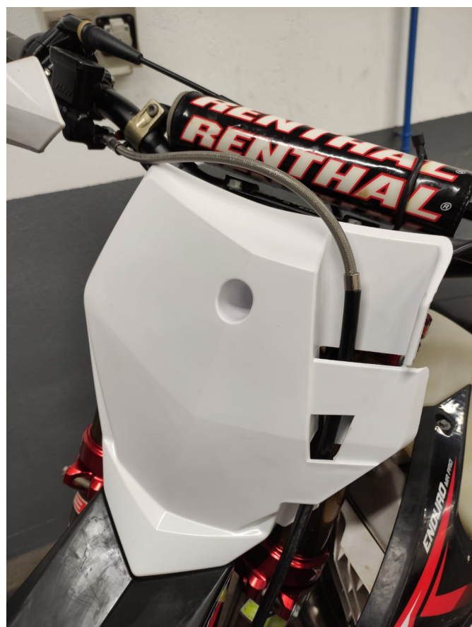
26. MONTAGE DU CARENAGE AVANT BE90500GG-MXC AVEC LA VIS 0 / 000.460.9161
