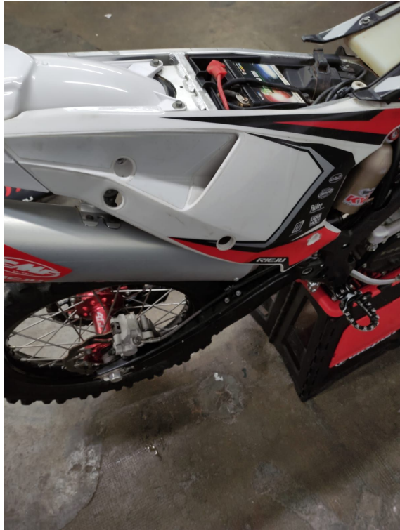
23. MONTAGE DUCARENAGE CÔTÉ DROIT
