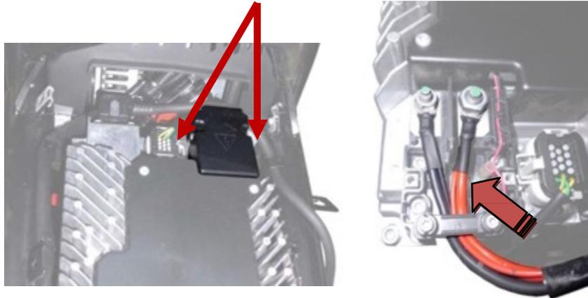
Los tornillos que sujetan los bornes deben estar correctamente apretados y en buen estado.
