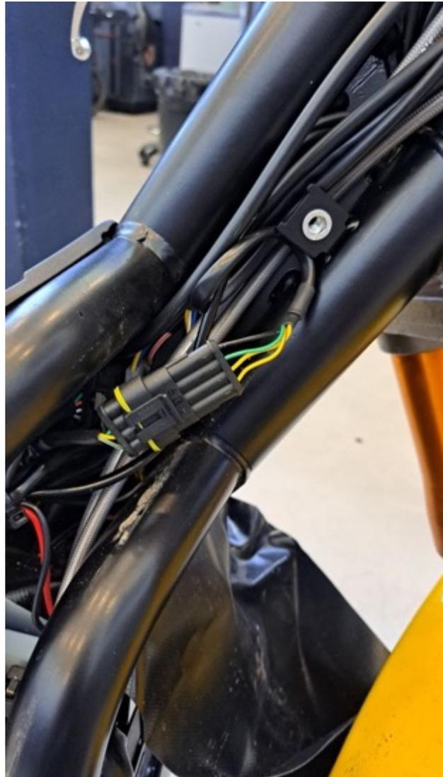
2. Verifique la continuidad de los cables del conector del display.
