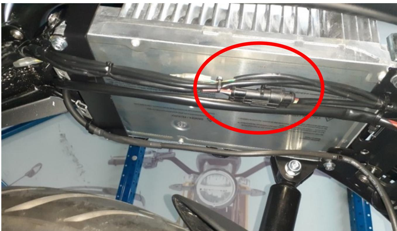
2.- Comprobar voltaje de alimentación en el conector del piloto de freno trasero en la instalación eléctrica de la moto (el lado de la moto). El voltaje entre los pines 41 y 40 debe ser 13 V con el vehículo encendido.
