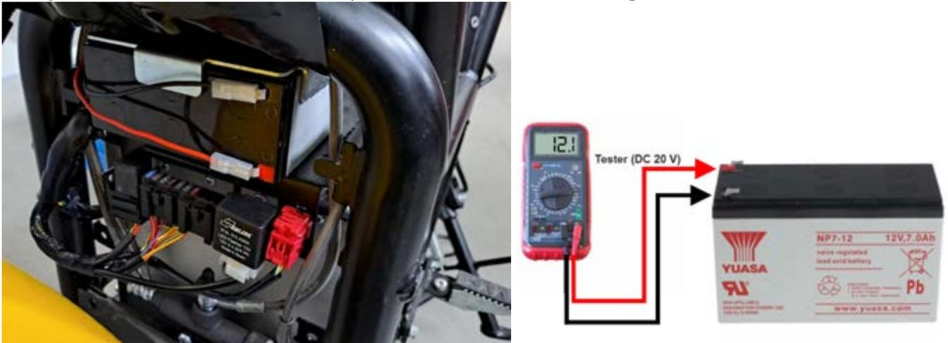
Si la batería presenta un voltaje inferior a 9 V, sustituya la batería de arranque por una nueva. En caso de duda, contacte con el servicio técnico.
