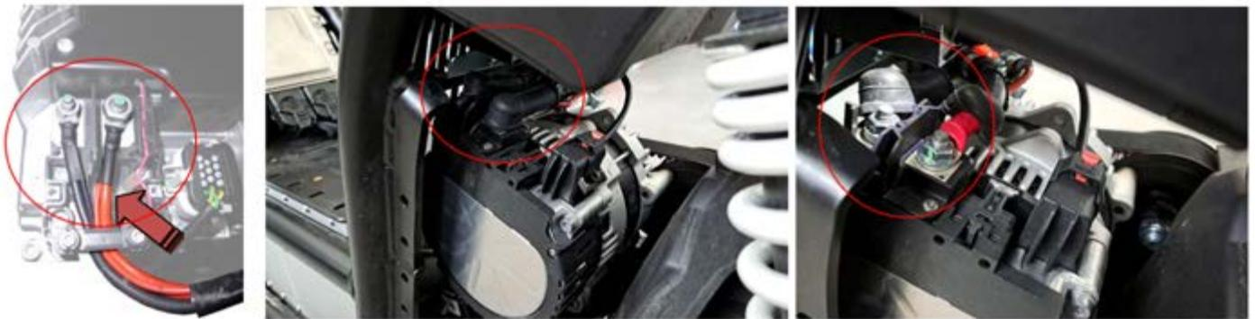
Verifique la continuidad entre borna del cargador y borna del motor del cable positivo con un multímetro, cable rojo.
