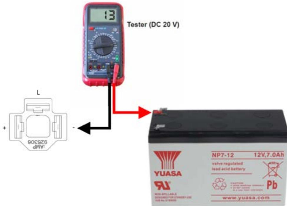
Con el vehículo encendido, la tensión entre el pin positivo del relé de intermitencia y el terminal negativo de la batería de 12 V debe ser de 13 V.
