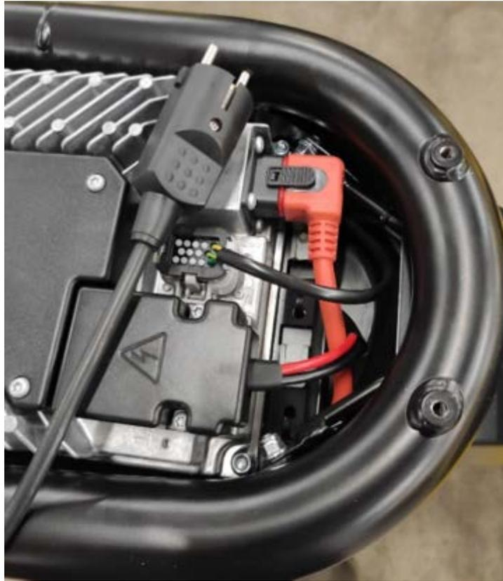
Suelte el conector del cargador apretando al mismo tiempo las pestaña superior e inferior del conector para liberarlo del cargador.
