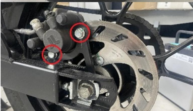
Utilice una llave torx para retirar los tornillos del repartidor de frenada (BMS)
