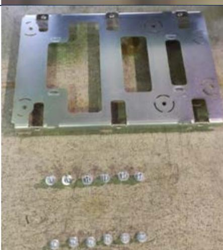
Suelte los tornillos que fijan la bandeja inferior al chasis; al volver a montarla, es importante mantener el orden indicado en la siguiente imagen de tornillo, arandela grover y arandela.
