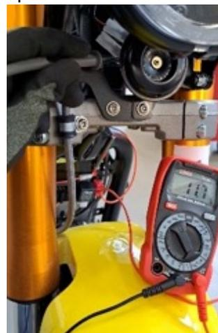
En caso **negativo**, compruebe la instalación eléctrica entre el pin A del claxon y terminal negativo de la batería.
