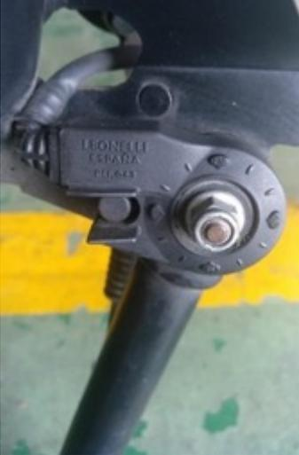
**1.- Desplegar el caballete lateral. Tras desbloquear la moto (freno pulsado + botón arriba), debe aparecer un mensaje en el Display: “Caballete”. Además, la función del acelerador se debe desactivar. Al replugar el caballete, el mensaje del Display debe desaparecer y la función del acelerador se debe restaurar.**
