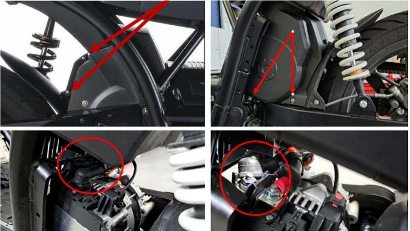
Compruebe que los cables rojos están conectados correctamente al motor, verifique la continuidad de los cables
