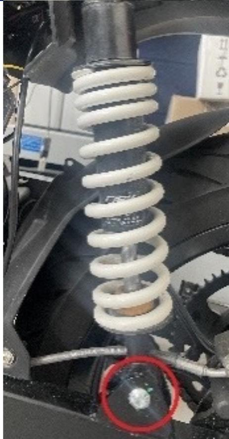
Utilice una llave de vaso del 19 y una llave fija del 22 para extraer el eje de la rueda trasera.
