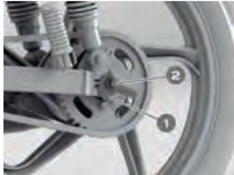
1. Tendeur de la chaîne de transmission. 2. Écrou de l'axe de la roue arrière.
