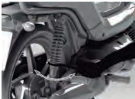
Mécanisme de réglage de la précharge.
