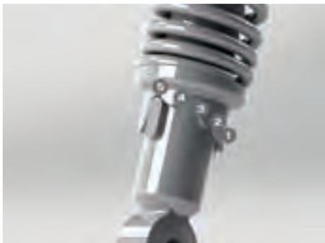
Niveles de ajuste de la precarga. 5. nivel mínimo de precarga - 1. nivel máximo de precarga.
