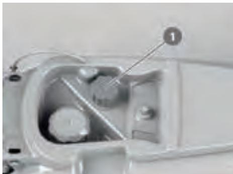
1. Bouchon du réservoir d'huile.
